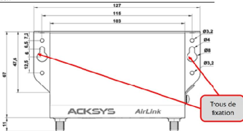
Il est possible de monter le produit sur un RAIL DIN à l'aide du kit **WL-FIX-RD2**
