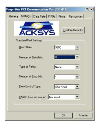
L'onglet "**Settings**" permet de définir les paramètres de communication initiaux, comme dans le cas d'un port de COM standard.
