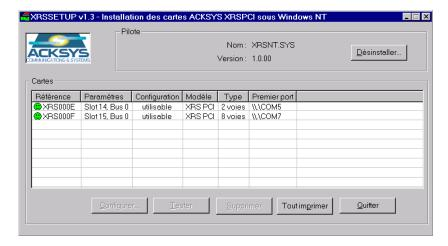
Dans cette fenêtre, vous verrez apparaître la liste des cartes détectées par le pilote. Vous pouvez alors cliquer sur le bouton **Quitter** pour terminer l'installation ou sélectionner une carte et cliquer sur le bouton "**Configurer** …" pour ouvrir la fenêtre *Propriétés de ACKSYS xRSPCI*.
