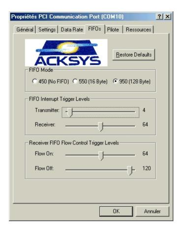
L'onglet **FIFOs** permet de fixer les seuils de déclenchement des interruptions d'émission et de réception en fonction du nombre de caractères présents dans les tampons respectifs, ainsi que les seuils pour le contrôle de flux. Les valeurs par défaut sont satisfaisantes pour la plupart des applications classiques.
