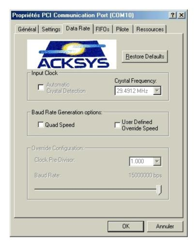
L'onglet '**Data Rate**' permet de configurer des modes de fonctionnement spécifiques de la carte et de visualiser la fréquence de l'oscillateur, qui doit être, pour les cartes standard, de 29,4912 MHz.
