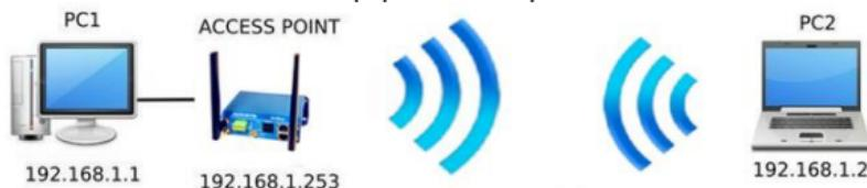
Paramétrez la connexion sans fil du PC2 selon les paramètres d'usine fixés dans le point d'accès.
