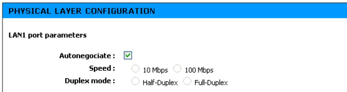
**Champ « Autonegotiate » :** Par défaut cette option est activée et permet de détecter automatiquement la vitesse de la communication ainsi que le mode duplex.
