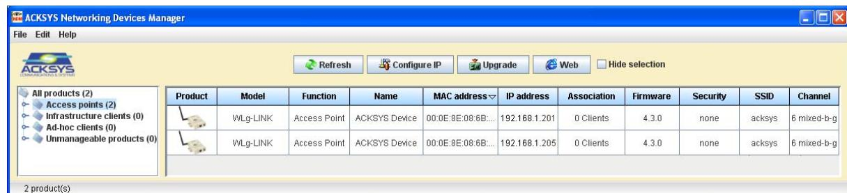
L'application détecte tous les produits ACKSYS de type points d'accès/bridge présents sur le réseau local, sélectionnez le ou les produits à configurer et cliquez sur le bouton « Configure IP ».
