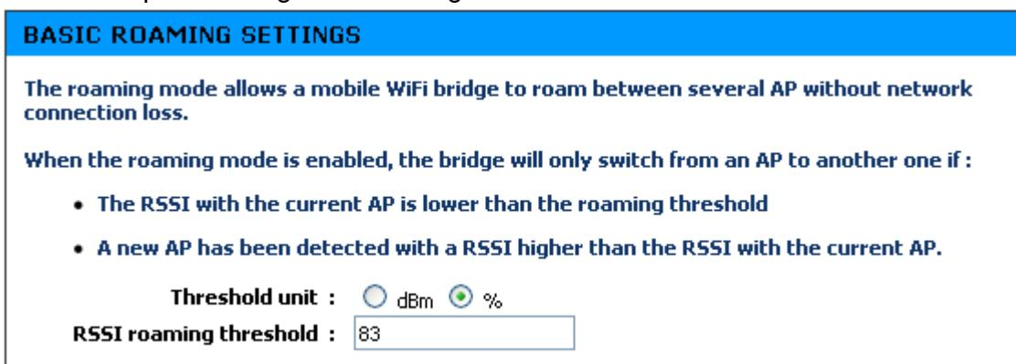
Elle permet de régler le seuil de basculement entre deux points d'accès. Il peut être exprimé en pourcentage ou en dBm.
