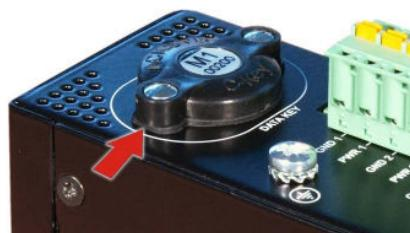
Pour monter une nouvelle C-Key, assurez-vous que le méplat est bien orienté vers l'arrière du boîtier, puis insérez-la verticalement dans l'ouverture, sans forcer, et vissez.
