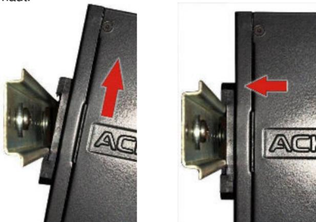
Pour extraire le produit du rail, procédez de la même façon, en tirant le boîtier vers le haut, puis en faisant pivoter la partie supérieure vers vous, de façon à dégager la griffe du rail.
