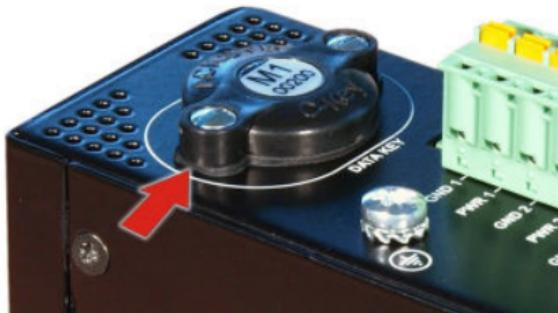
Pour monter une nouvelle C-Key, assurez-vous que le méplat est bien orienté vers l'arrière du boîtier, puis insérez la verticalement, sans forcer, dans l'ouverture, et vissez.
