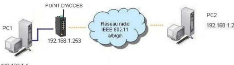
Paramétrez la connexion sans fil du PC2 selon les paramètres fixés dans le point d'accès.
