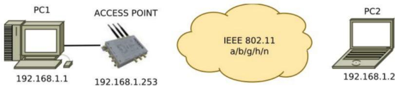
Paramétrez la connexion sans fil du PC2 selon les paramètres d'usine fixés dans le point d'accès (802.11gn, SSID acksys, sans sécurité).
