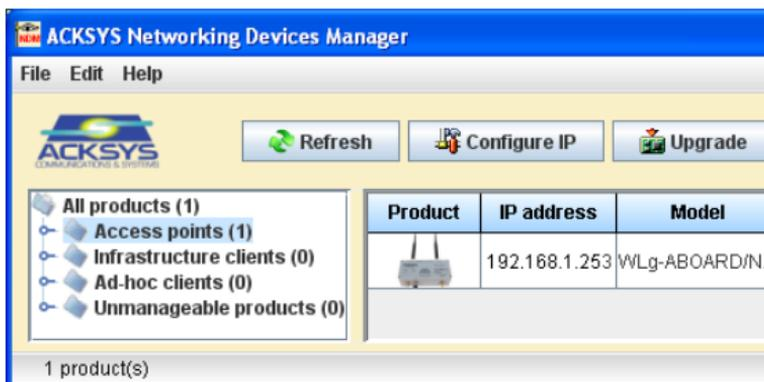
Attention, le champ « Model » est initialisé avec le nom générique « **WLg-ABOARD/N\_V3** » pour les produits **WLg-ABOARD/NI**, **WLg-ABOARD/NPI**, **WLg-ABOARD/N\_V3** et **Wlg-ABOARD/NP\_V3**.
