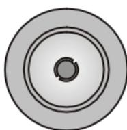
Le connecteur d'antenne « Main » reçoit l'antenne principale, pour l'émission et la réception de données.
