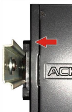
Pour extraire le produit du rail, procédez de la même façon, en tirant le boîtier vers le haut, puis en faisant pivoter la partie supérieure vers vous, de façon à dégager la griffe du rail.
